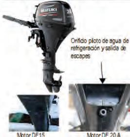
Orificio piloto de agua de refrigeración y salida de escapes
