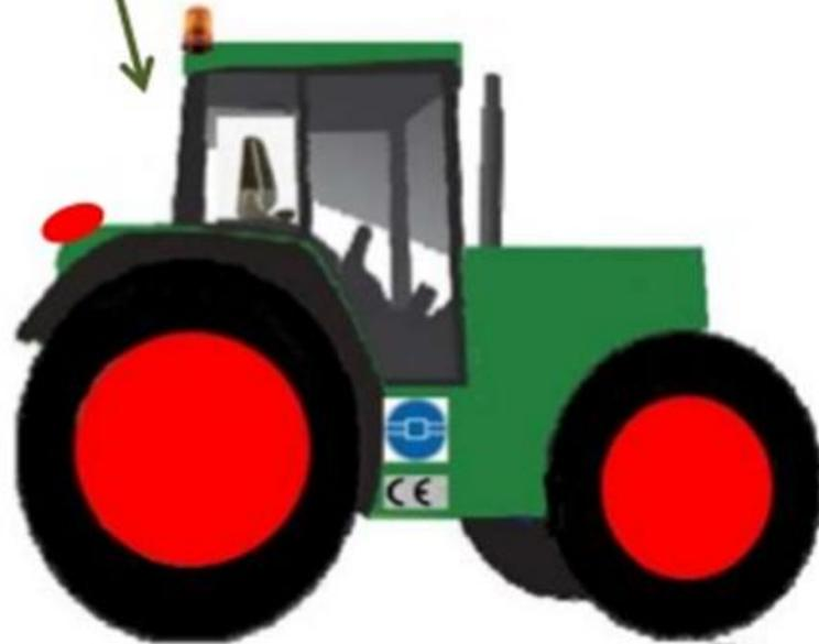
De acuerdo con la legislación vigente, todos los tractores tienen que tener una **ESTRUCTURA DE PROTECCIÓN CONTRA EL VUELCO** (cabinas, bastidores de 4 ó 6 postes o arcos de 2 poste delanteros o traseros ).
