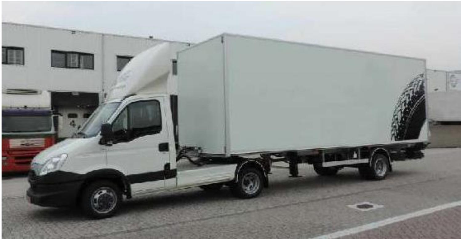
**Vehículo tractor hasta 3500 kg + semirremolque hasta 3500 kg**
