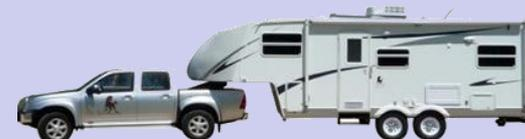
*Remolque ligero: hasta 750 kg. Remolque pesado: más de 750 kg (este último tiene que matricularse). Consultar tarjeta ITV para ver MMA remolcable con freno y sin freno propio.*
